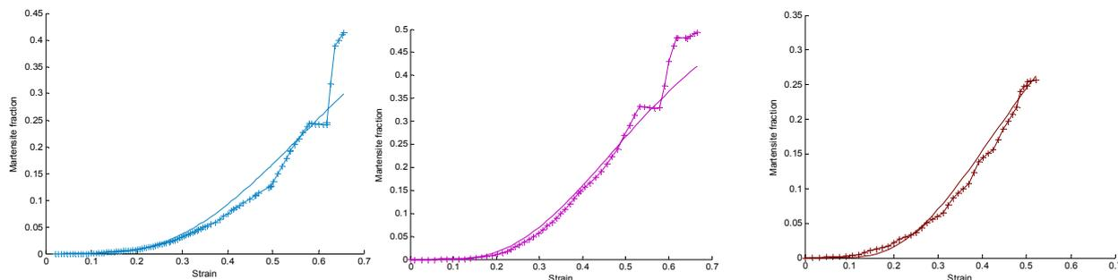
Fig. 5: Strain versus  $\alpha$ -martensite fraction a)  $10^{-4} \text{ s}^{-1}$  b)  $10^{-3} \text{ s}^{-1}$  c)  $10^{-2} \text{ s}^{-1}$
