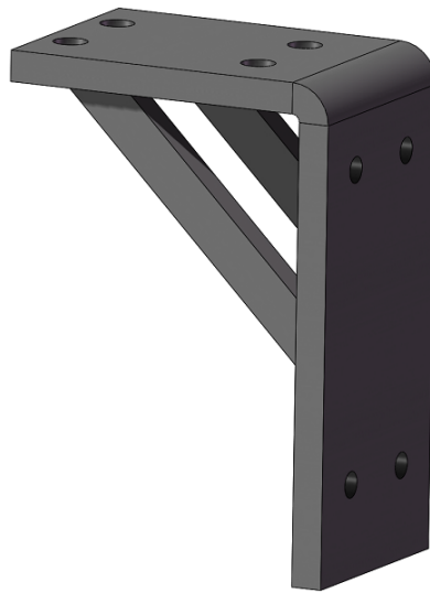
Figur 7.5.1. Konsol till lagerbockar.
