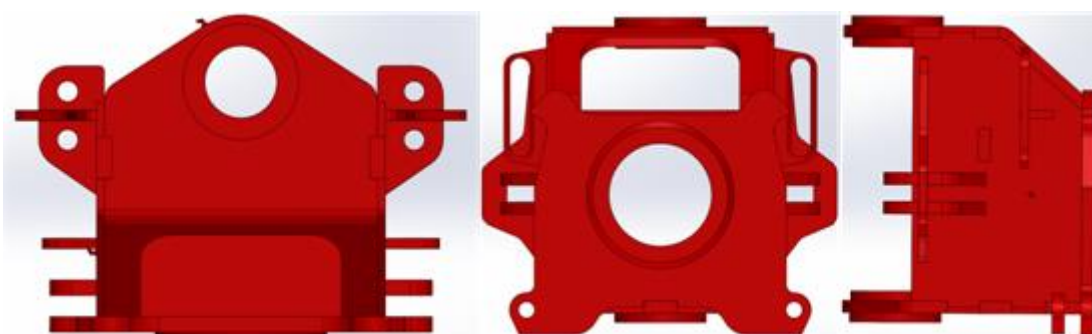
Figur 34. Nya förhöjda midjeleden med dedikerat utrymme för slanggenomföring.
