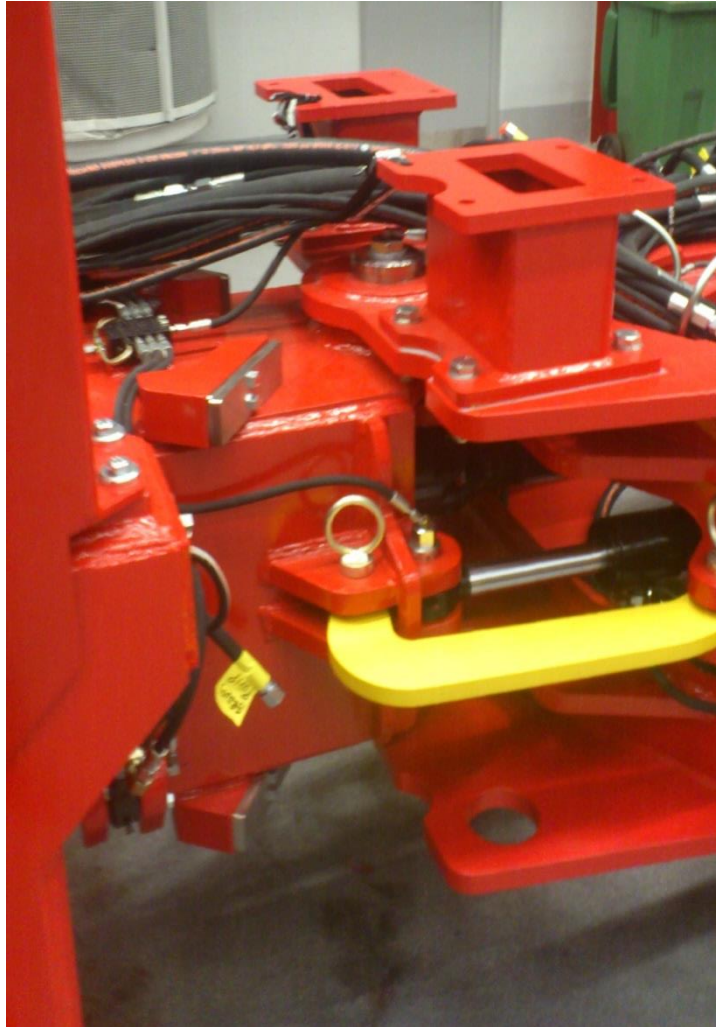
Figur 1. Maskinens midja med tillhörande hydraulik samt drivaxel.
