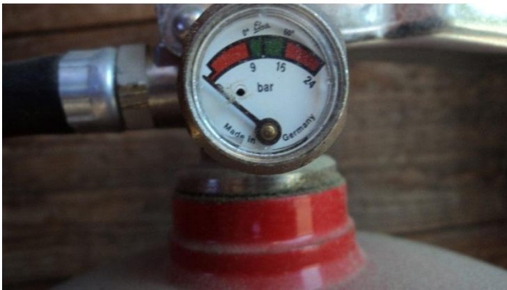
Figur 14. Skumsläckare i snickeriet som saknar tryck. (Edström, 2012)
