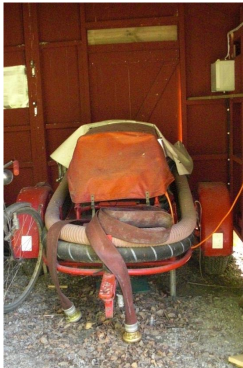
Figur 18. Till vänster karta över var det finns brandslang och påkopplingsenheter. Till höger motordriven brandpump. (Edström, 2012)
