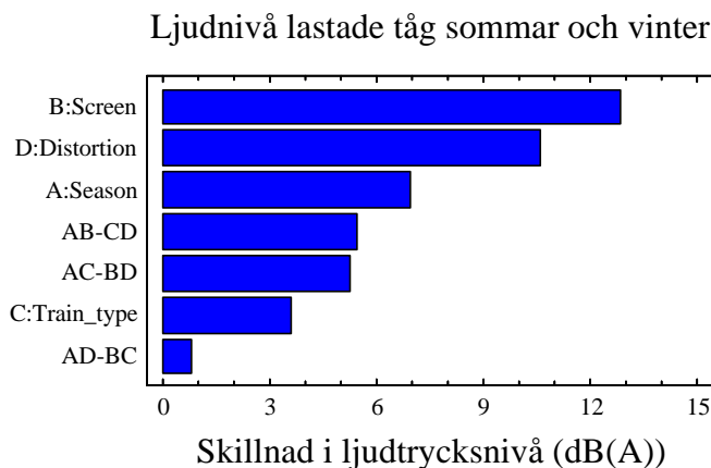
Figur 6.8 Analys 1B, beräknade skillnader i A-vägd ljudtrycksnivå i förhållande till olika bakgrundsfaktorer enligt tabell 6.2.
