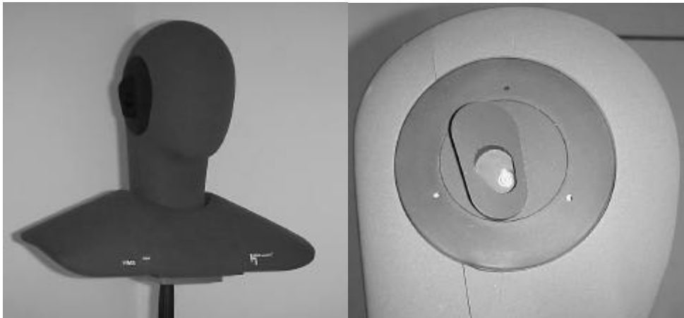
Figur 3.7 Konsthuvud HMS III från HEAD Acoustics, mikrofon finns vid vardera öroningångsöppning.
