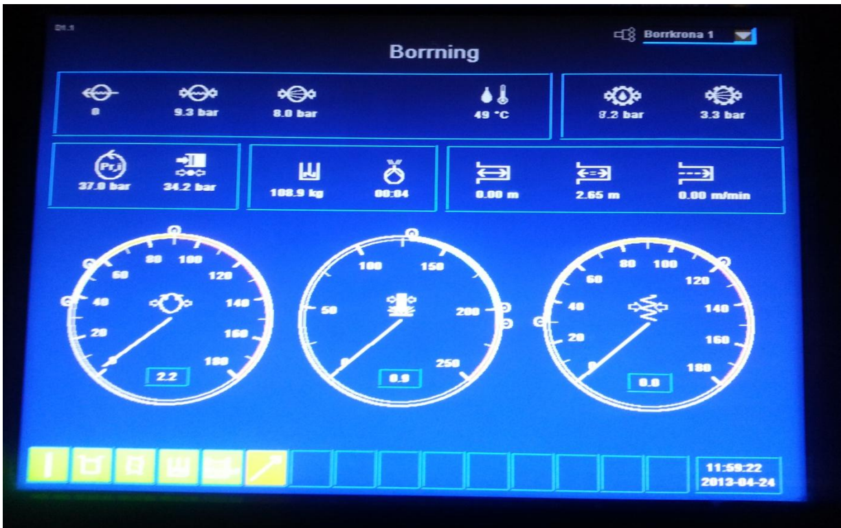
5. RCS i Boltecen. Här visas total borrlängd, rotationshastighet, olika tryck och hur mycket cement det är kvar i blandaren. Foto: R.Forsell
