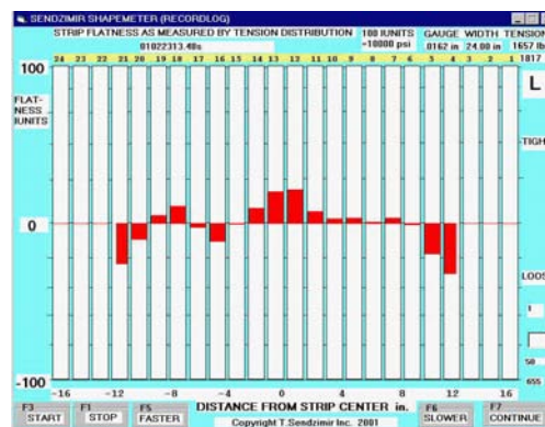
Bild 17: Exempel på en shapemeters avläsning av spänningsfördelningen i ett band [1, 4]
