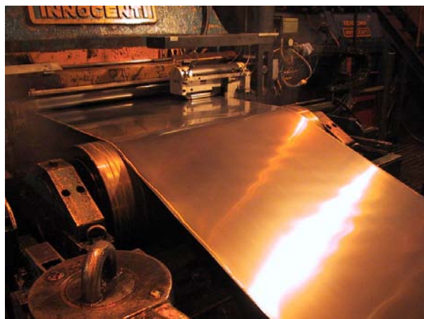
Bild 39: Revbensmönster under valsning av stick 3
