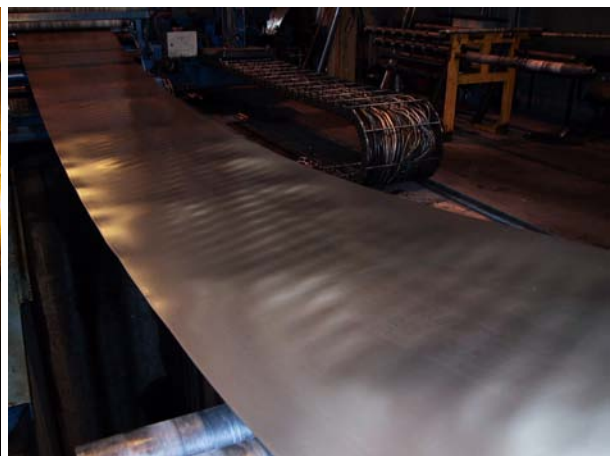
Bild 49: Revbensmönster, 3 stick + trimvalsning
