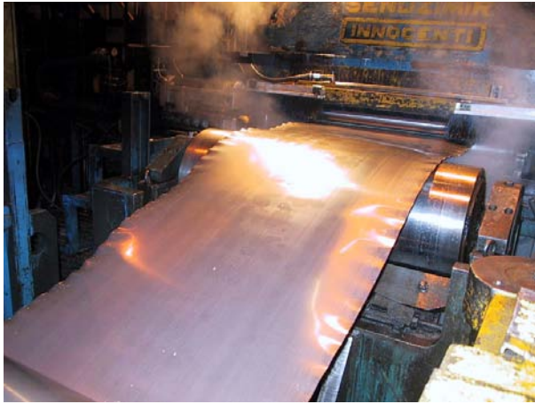
Bild 20: Verket stoppat pga. slirning under stick 1
