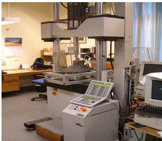
Figur 48 - Utmattningsrigg vid stålforskningen, hela riggen. Figur 49 - fixturen i riggen.
