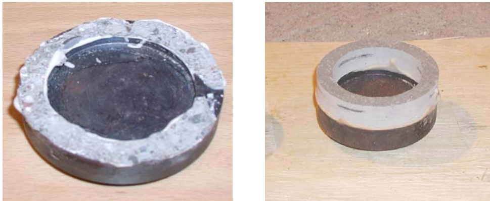
Bild A12. T.v. provkropp efter utfört torq-test på betongplattan, t.h. provkropp efter utfört torq-test på betongplatta med pågjuten polymerbetong.
