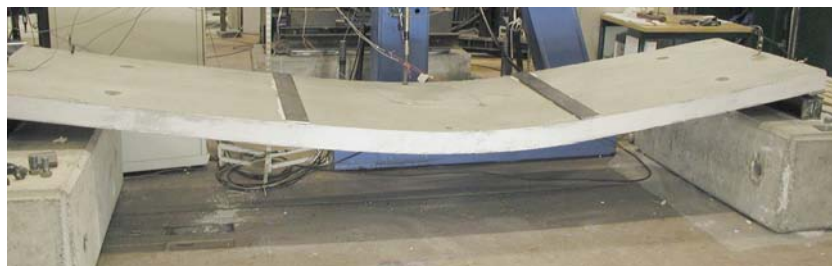
Bild A2. Kvarstående deformation i platta 1 efter avslutat försök.
