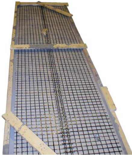
Bild A8. Kolfibernet samt gjutform utlagt på betongplatta.
