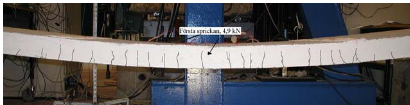
Bild A6. Sprickkartering platta 5. Sprickmönstret är synonymt för alla testade plattor.
