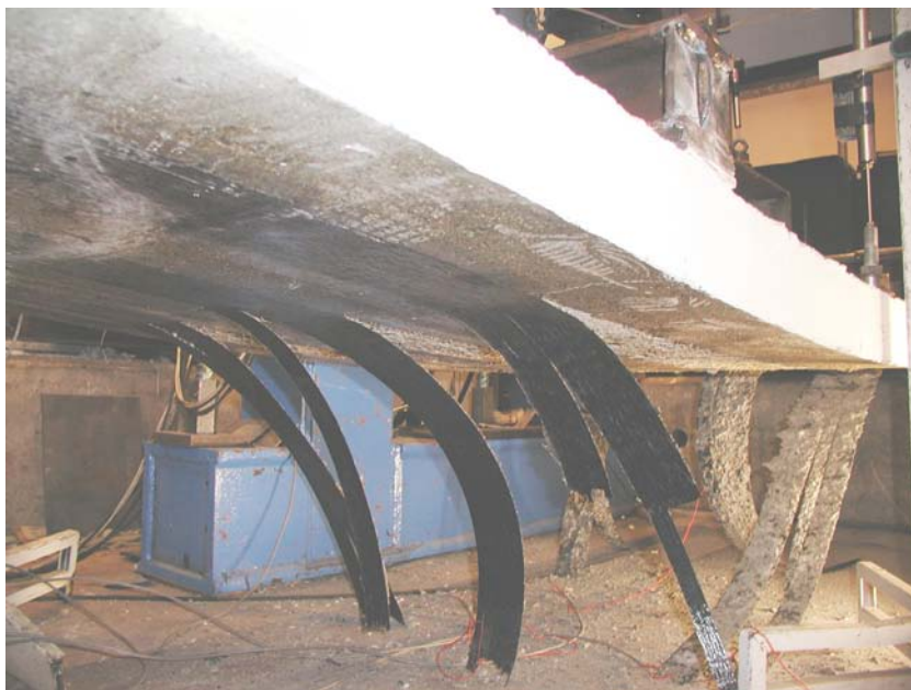
Bild A5. Fiberväv efter brott i platta 4.
