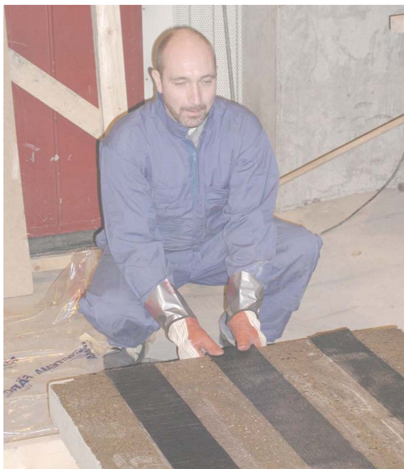
Bild A10. Limning av väv på platta 4 (även handledaren drog på sig blåstållet).
