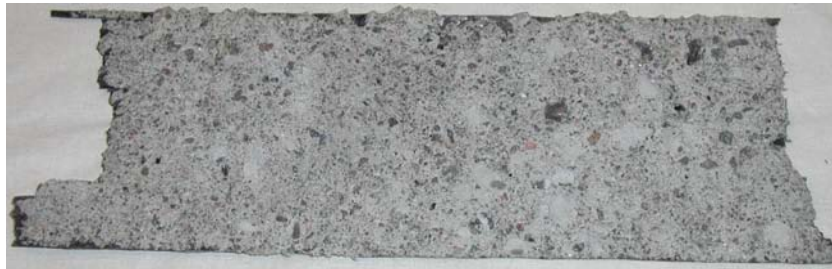
Bild 5.1. Kolfiberkomposit med lossryckta betongpartiklar.
