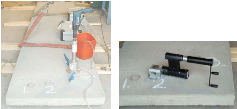
Bild A11. T.v. utrustning för uppborrande av den specifika yta som torq-testet skall utföras på, t.h. kraftmätaren för vridning av provklacken.
