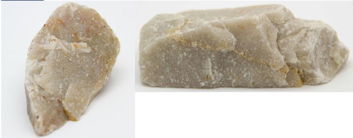
Figur 13. Stuff nummer. 1 och 4 av Tornio. Homogen finkornig kvartsit med impregnering och av järnoxider.
