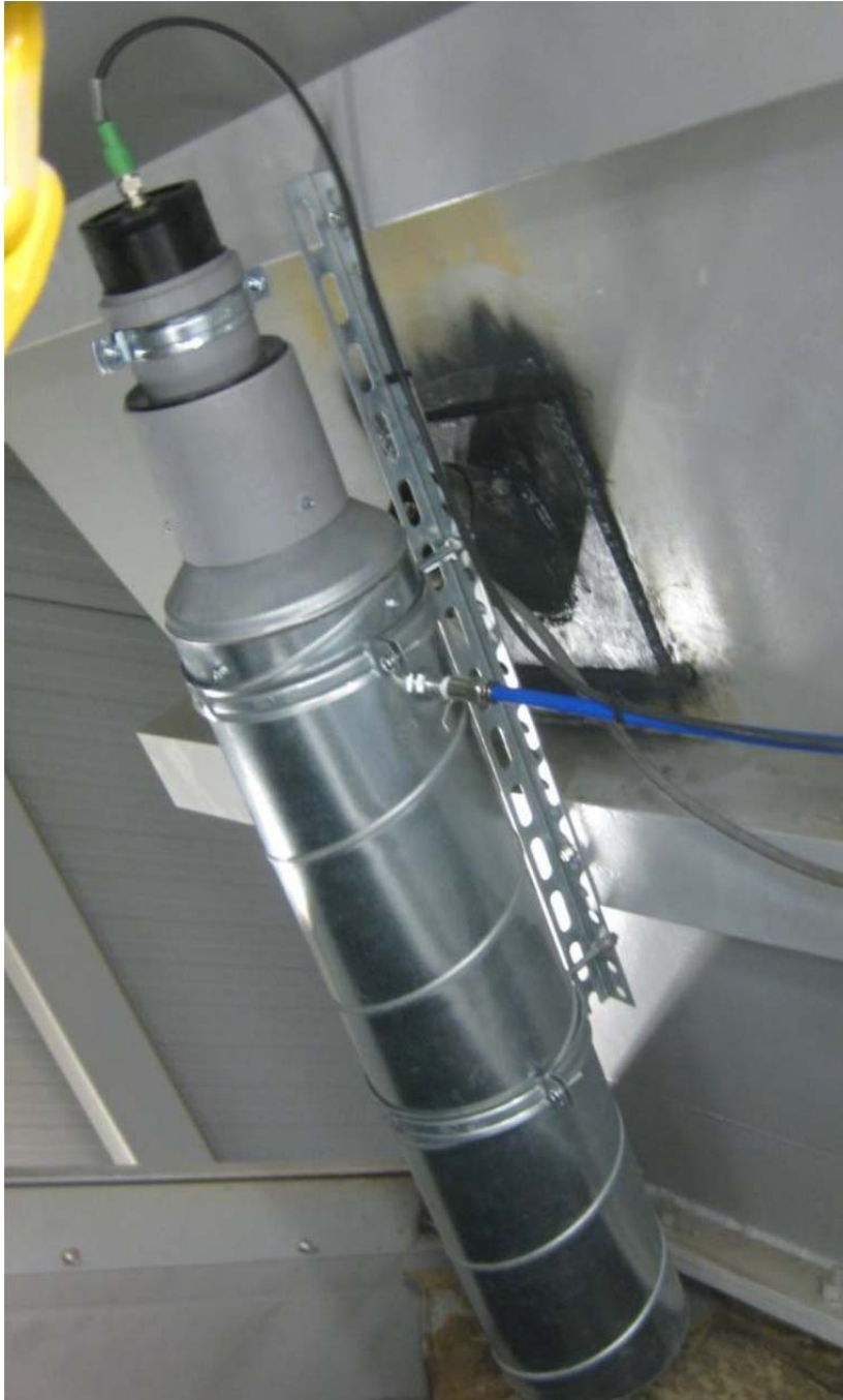
Figur 2 Fukthaltsmätning sitter på stativet
