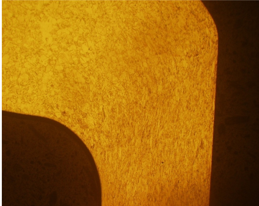
Bild 5: Bilden visar hur materialstrukturen ser ut efter den första dragpressoperation.
