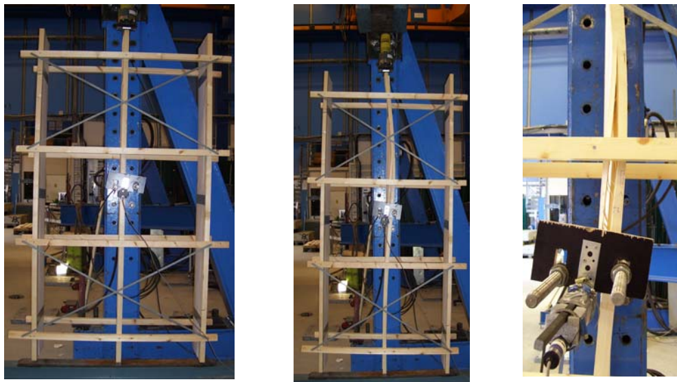
Figur 4.9 Provkropp 2.2 innan försök (till vänster) och efter brott (i mitten). Till höger syns spjälkning mellan 1: och 2:a förband.
