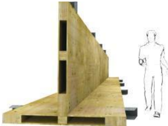
T-formen gör stabiliseringselementet stabilt i sig självt och därför behövs mindre stagning vid monterat. Stabiliseringselementen utnyttjas som stagning för pelare och balkar som monteras mot dessa. Foto: Moelven
