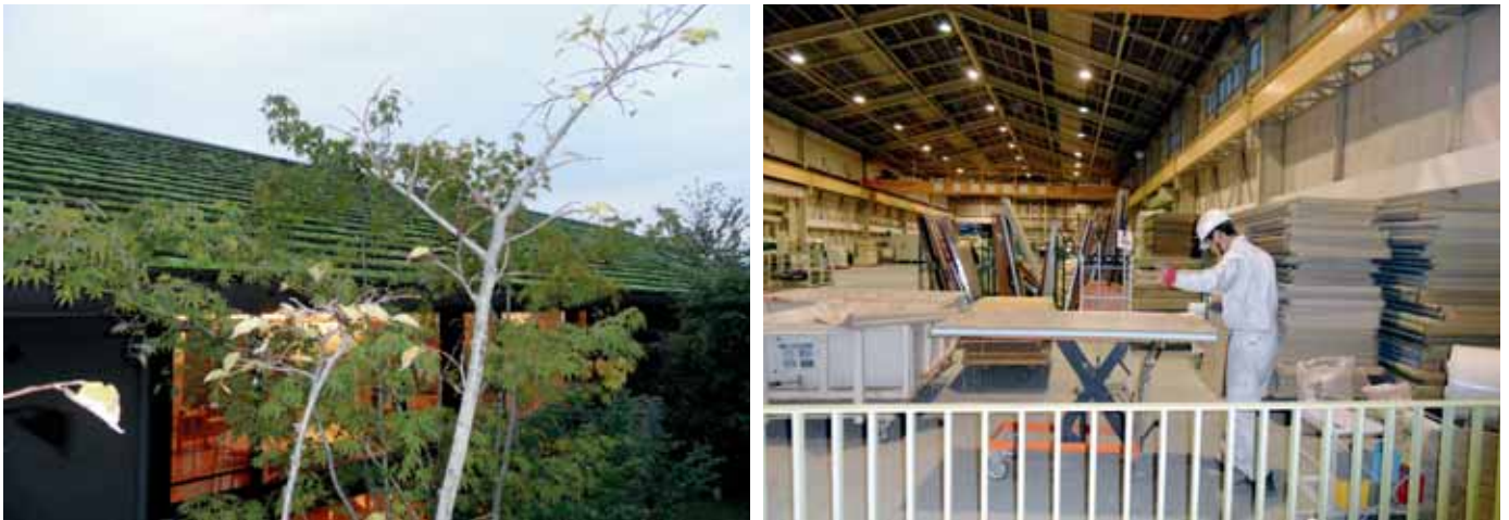
Figur 4. Vänster; växande gräs på demonstrations husets tak. Höger, En arbetare visar hur man plockar isär och utvinnet material ur ett väggblock av kompositmaterial.
