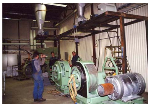
Figur 8. Seskarö industriområde, med flislager och panncentral till vänster. Installation av pelletspressar i snickerilokal till höger (Källa: Seskarö-bladet april nr 4 2003).
