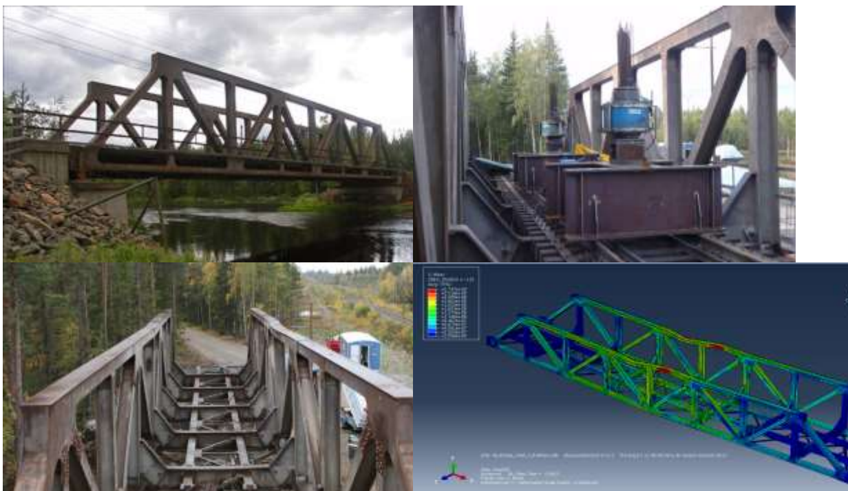
Figur 2.2: Stålbros från Åby Älv provad till brott i september 2013 i EU-projektet "Mainline" Till vänster: Lastpåföring med domkrafter och injekteringsförankrade stag Nedtill: Knäckning i överrannsstänger i verkligheten och enligt finit element modell. Haggström et al. (2014, 2015).
