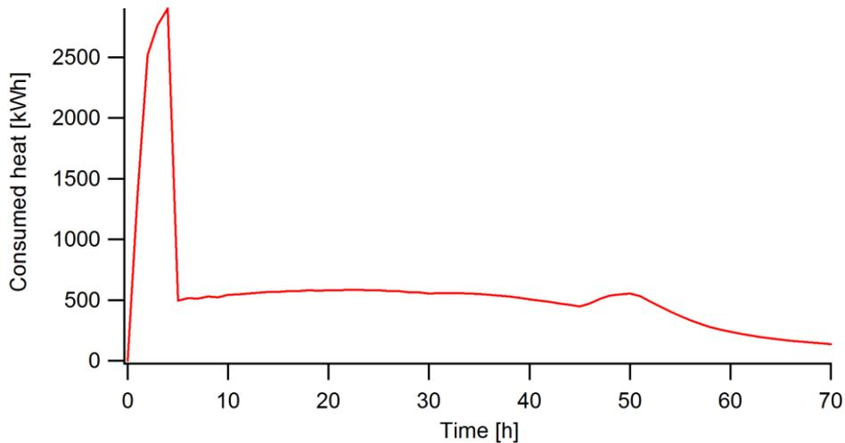
FIGURE 9 - HEAT PROVIDED FROM THE HEATING BATTERY OVER TIME
