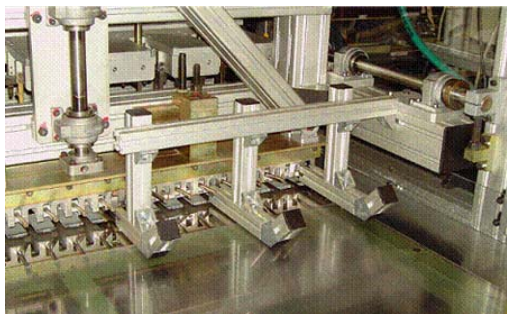
Figur 42 Skenor under vilka kroken fixeras
