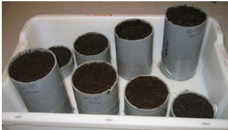
Figur 26 Plaströren fylldes med torv som ställdes i en plastback som i sin tur placerades i ett rum med konstant temperatur + 30 grader C.
