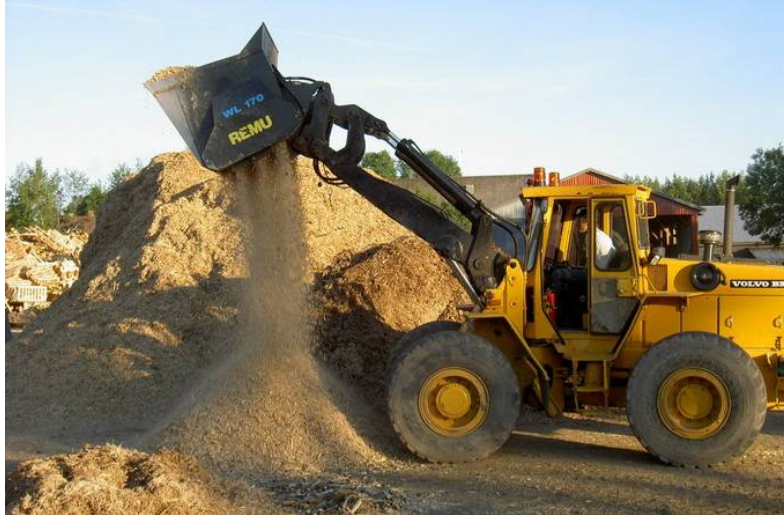
Figur 2 Visar principiellt hur en Remuskopa fungerar, material sönderdelas och större stenar, grenar m.m. avskiljs i skopan.
