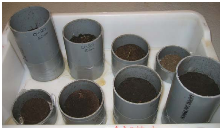
Figur 27 Figuren visar hur mycket torven minskat i volym efter torkning i ca 3 veckor. Ingen vändning eller omrörning har gjorts.
