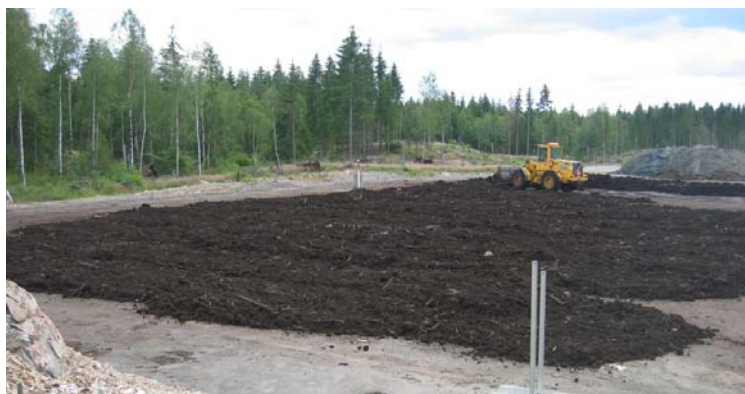
Figur 29 Torv utlagd för saltorkning. Torven vänds med skopa på hjullastare en gång varje dag genom att all torv först samlas ihop i en hög och därefter sprids ut på asfaltsytan igen.
