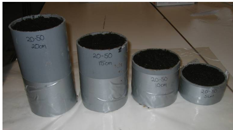
Figur 1 Torkförsök med torv i olika tjocka lager. Fyra plaströr 5, 10, 15 och 20 cm höga är på bilden fyllda med höghumifierad torv, 20-50 cm.
