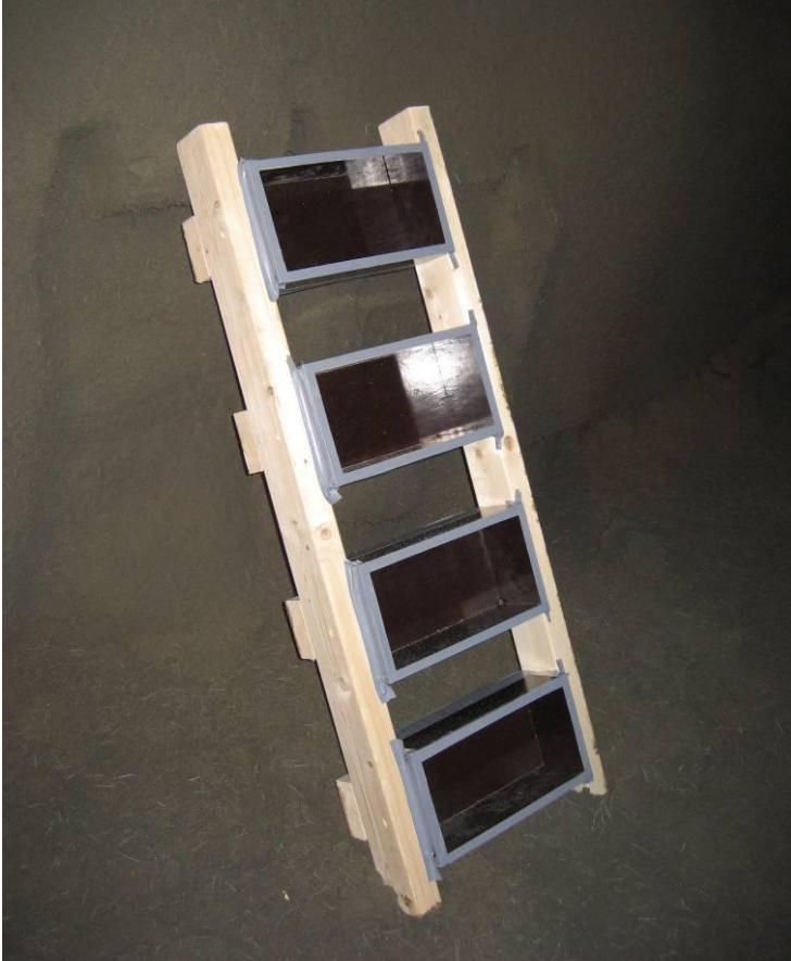
Figur 8-1 Provram med 4 formar, som lutas mot bergvägg.
