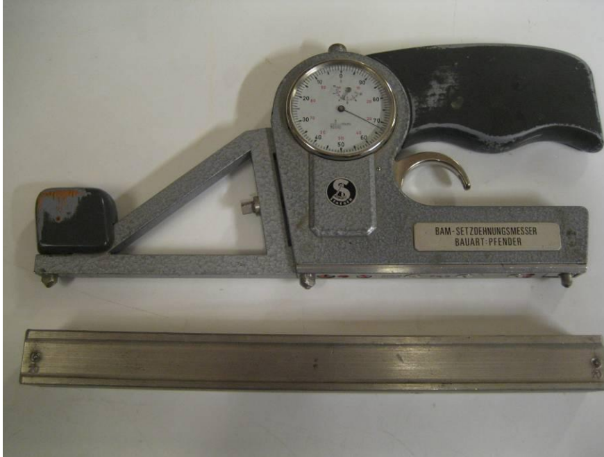
Figur 7-5 Extensometer (Saeger) för mätning av prismornas krympning
