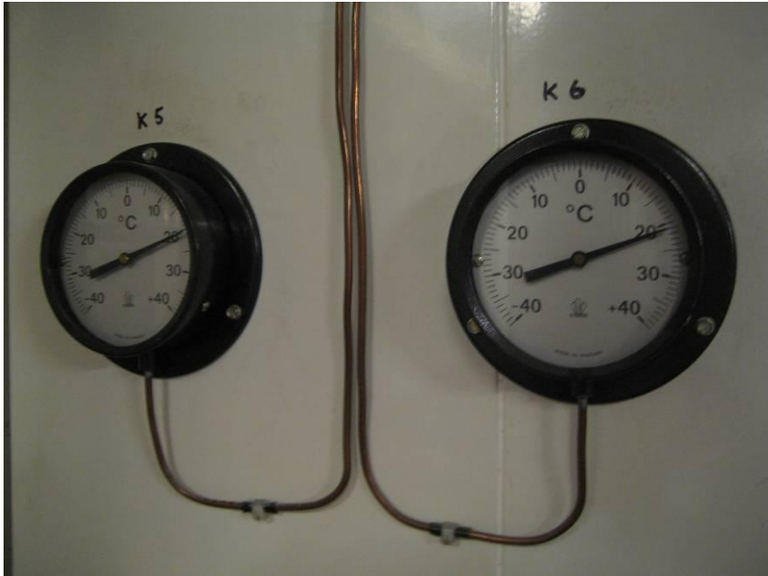
Figur 7-9 Temperaturgivare för de två klimatrutorna.
