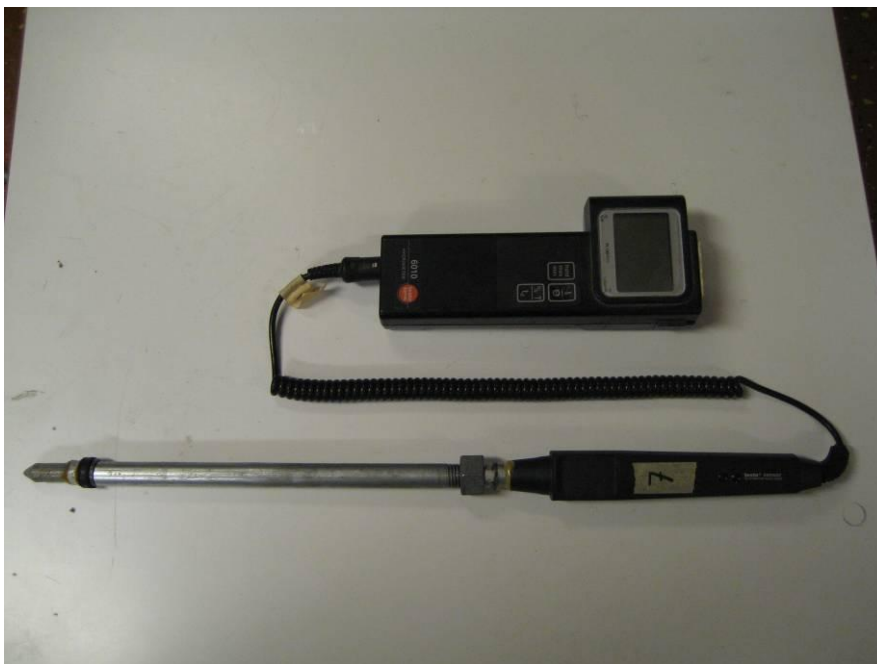
Figur 7-8 Givare och digital enhet för mätning av relativ fuktighet.
