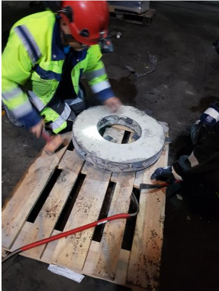
Figur 3. Prov 1, sprutbetong ej vattenhärdad.
