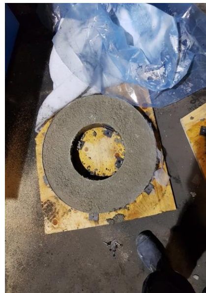
Figur 6. Prov 4, Gjuten betong vattenhärdad.
